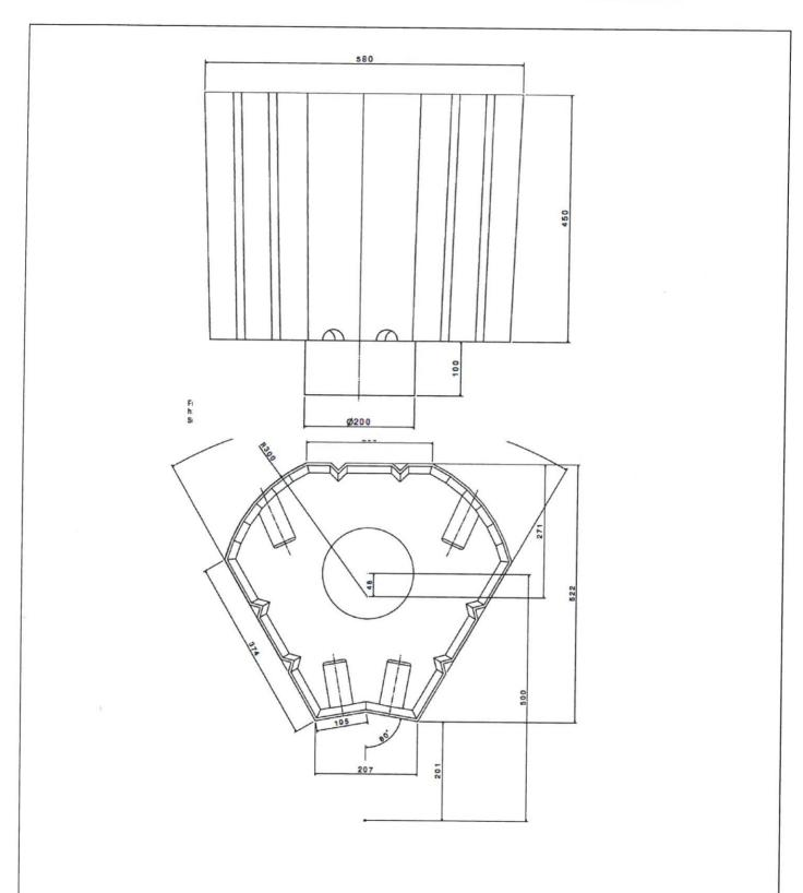
Anlage zur Behandlung von mineralölhaltigen Niederschlagsabflüssen für die Versickerung 3P Hydrosystem 1.500
