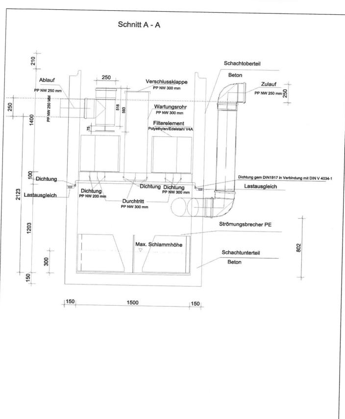
Anlage zur Behandlung von mineralölhaltigen Niederschlagsabflüssen für die Versickerung
