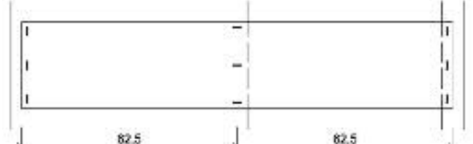
Klammerbild der Direktverklammerung in Wandstiele
