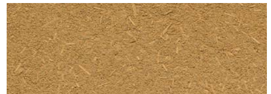
Lehmunterputz, trocken, gerieben
