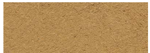
Lehmunterputz, erdfeucht mit Flachsfasern, gerieben
